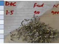
Fig. 11 DOC=1.5mm, Vc=900 m/min result
