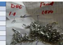
Fig. 15 DOC=1.0mm, Vc=1000 m/min result
