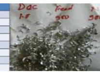
Fig. 14 DOC=1.0mm, Vc=900 m/min result
